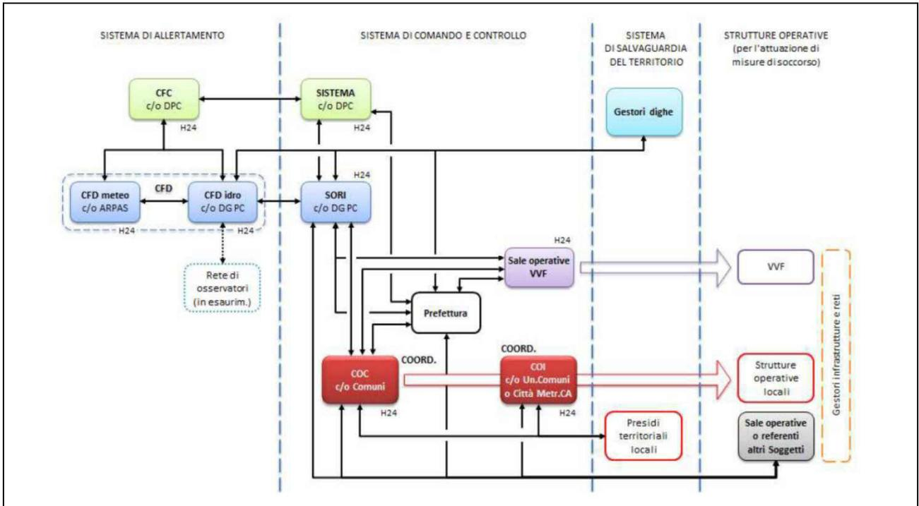
Figura 4 - Schema operativo fase di Allarme "tipo a"
