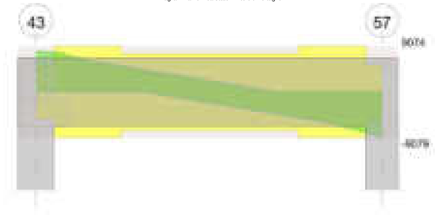
Diagramma verifica stato limite esercizio quasi permanente freccia
