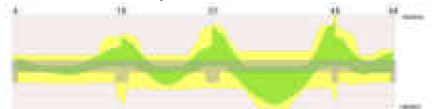
Diagramma verifica stato limite ultimo taglio
